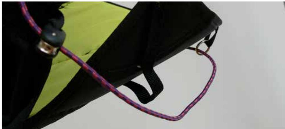
Zum Einstellen des Beschleunigers ist es sinnvoll, bereits vor dem ersten Flug in einem Gurtzeugsimulator erste Grundeinstellungen vorzunehmen. Idealerweise stellt man diesen so ein, dass bei eingehängten Verbindungsgliedern (Brummelhaken) das Speedsystem ca. 15 cm unter dem Gurtzeug hängt. Stellt man das System zu kurz
