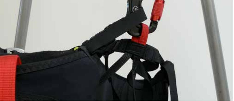
Die unteren beiden Schnallen werden jeweils links und rechts außen an der Hauptaufhängung der Beinschlaufen eingehängt.
