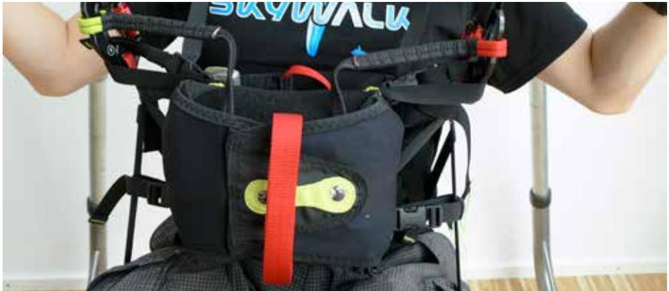
Die V-Leine (Retterverbindungsleine) wird ebenfalls (rot links und grün rechts) in die Hauptkarabiner eingehängt und ordnungsgemäß mit dem Rettungsgerät verbunden.
