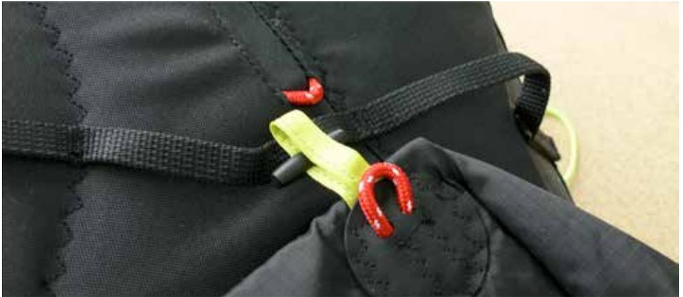
Im nächsten Schritt wird das Verbindungsstück durchgezogen und zurück durch die rote Schlaufe am Airbag geführt.
